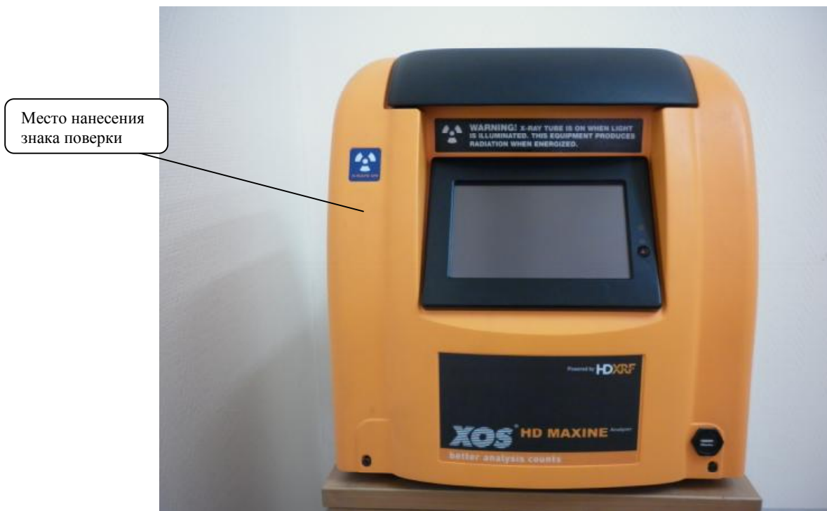
Рисунок 1 - Спектрометр рентгенофлуоресцентный многоэлементный HD MAXINE
